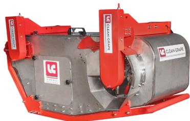
La camera di diraspatura confina l'azione del rotore evitando di frantumare foglie e raspi lungo la catenaria di cernita ed eliminandoli rapidamente.
